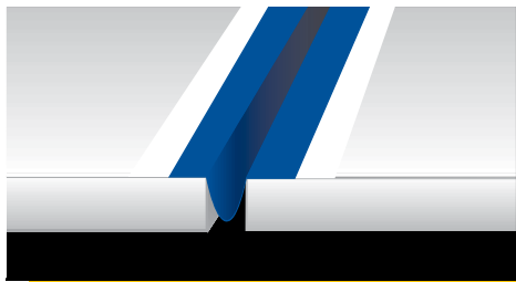
Colocación en omega de Mapeband en el interior de la junta de dilatación
